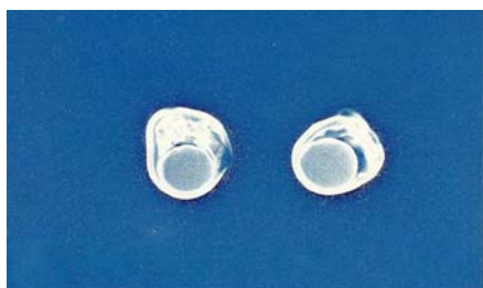
Fig. 2 - Xeroradiografia di una coppia di perle barocche coltivate con nucleo. In questa immagine i nuclei sono perfettamente distinguibili.
